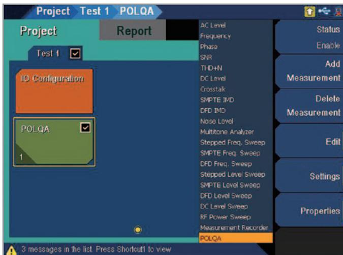
图6. 测试序列控制功能提供预配置测量选择，允许用户选择最常用的测试序列以提升日常测量任务的效率。
