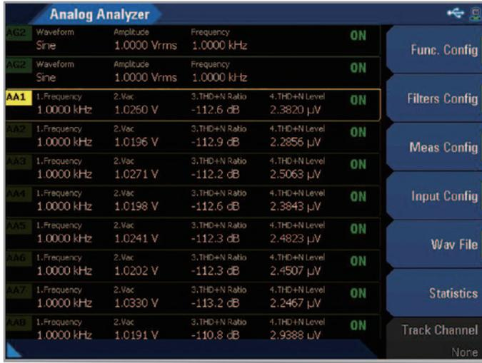
图 1. U8903B 图形用户界面显示的 8 分析仪通道测量结果。
